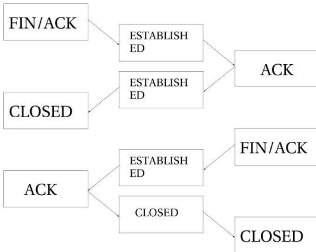
Как видно из рисунка, соединение не закрывается до тех пор пока не будет передан последний пакет *ACK*. Обратите внимание -- эта картинка описывает нормальный процесс закрытия соединения. Кроме того, если соединение отвергается, то оно может быть закрыто передачей пакета *RST* (сброс). В этом случае соединение будет закрыто по истечению предопределенного времени.
