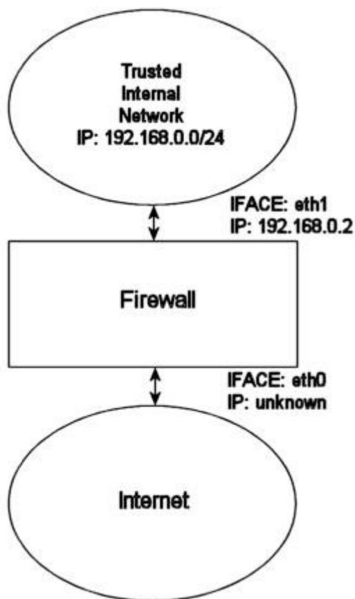
Сценарий The [rc.DHCP.firewall.txt](#) очень похож на оригинал [rc.firewall.txt](#). Однако, этот сценарий больше не использует переменную **STATIC\_IP**, это и является основным отличием от оригинала [rc.firewall.txt](#). Причина в том, что [rc.firewall.txt](#) не будет работать в случае динамического IP адреса. Изменения, по сравнению с оригиналом - минимальны. Этот сценарий будет полезен в случае *DHCP*, *PPP* и *SLIP* подключения к Интернет.
